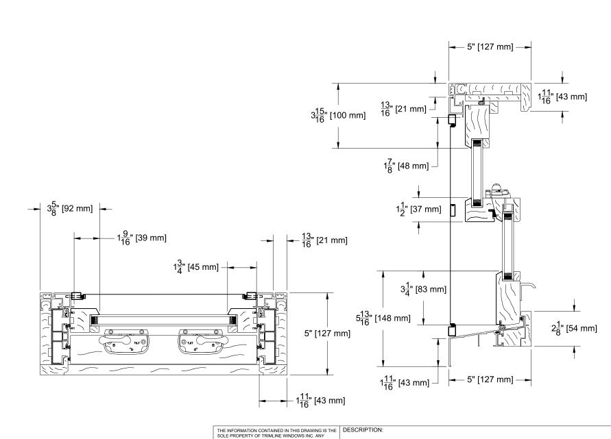
ECLIPSE | LEGENDS SERIES ALUMINUM CLAD-WOOD **DOUBLE HUNG FULL JAMB**
