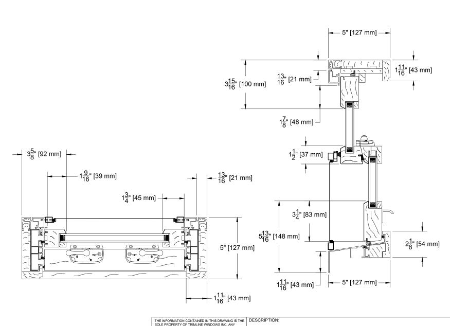
ECLIPSE | LEGENDS SERIES ALUMINUM CLAD-WOOD **DOUBLE HUNG FULL JAMB**
