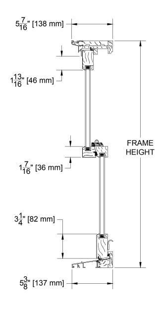
**ECLIPSE SERIES** MODEL EC300 ALUMINUM CLAD WOOD **DOUBLE HUNG**
